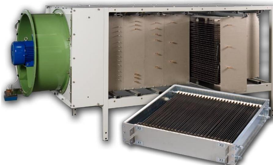
Компания JOVYATLAS использует в серии ML модульные блоки сопротивлений. Отдельные ступени нагрузки устанавливаются в виде вставных модулей в корпус резисторного блока. За счет специального конструктивного исполнения и согласованных с ним вентиляторов мы достигаем равномерного распределения тепла в резисторном блоке.
